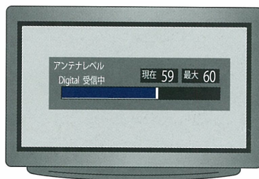
図2-11 デジタル受信機のアンテナレベル表示
